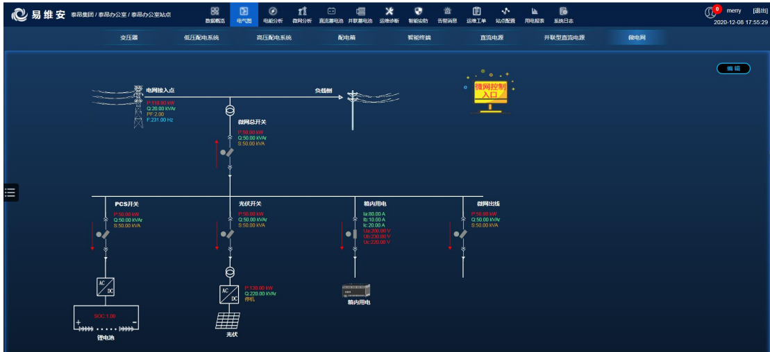
图 37 微电网电气图
